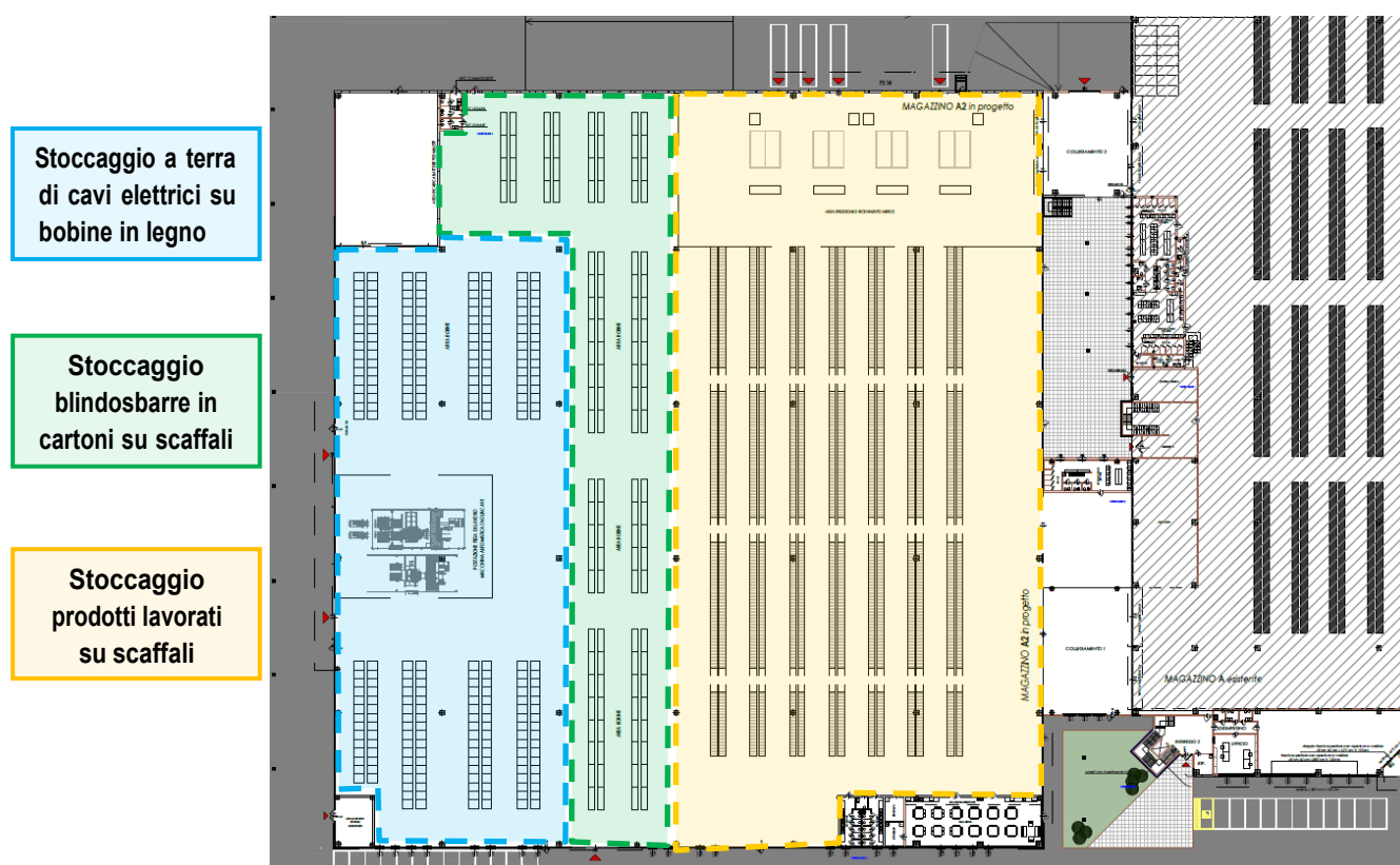
Fig. 3.1.1 – Individuazione aree omogenee per tipologia di stoccaggio ( IPOTESI ) nell'edificio oggetto di modifica
